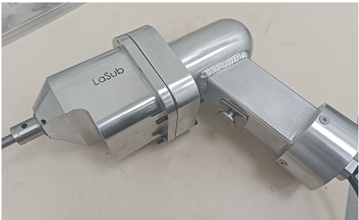
Figura 65 – Soldagem realizada entre o corpo do motor e a empunhadura.
