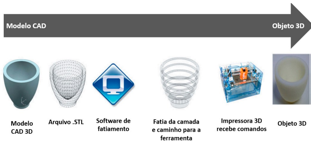
Figura 27 – Etapas da prototipagem rápida por manufatura aditiva.
