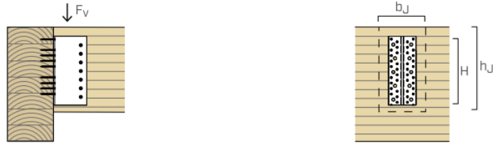
Figura 76 - Informações técnicas da ligação oculta com furos com cavilhas autoperfurantes SBD relativos à força cortante.
