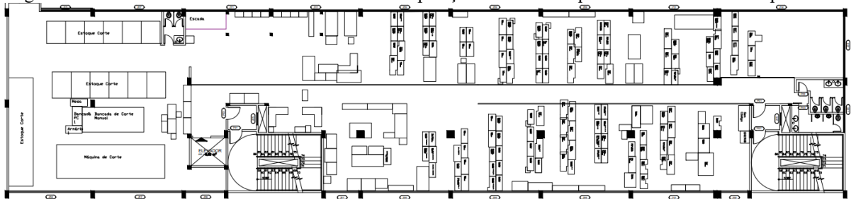
Figura 10. Planta baixa de cada setor evidenciando as posições de cada máquina e suas dimensões específicas.
