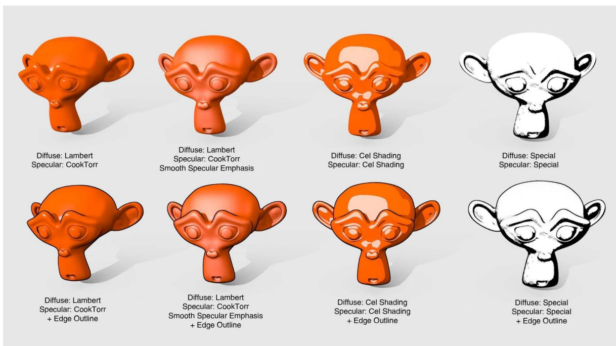
Figura 19 - Diferentes combinações de shaders com resultados distintos, incluindo cell shading.
