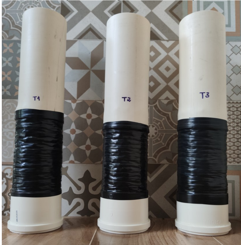
Figura 8 - Aparato para realização do ensaio de permeabilidade.
