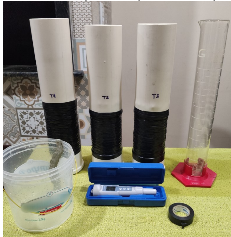
Figura 7 - Materiais utilizados para realização do ensaio de permeabilidade.
