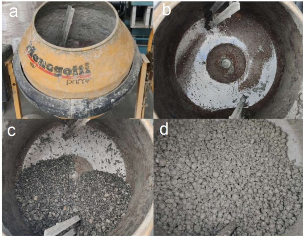
a) Betoneira utilizada; (b) Betoneira úmida; (c) Agregados graúdos e água misturados; (d) Mistura do concreto pronta.
