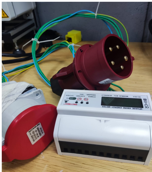
Figura 24 – Medidor de energia trifásico e conectores de cinco pinos
