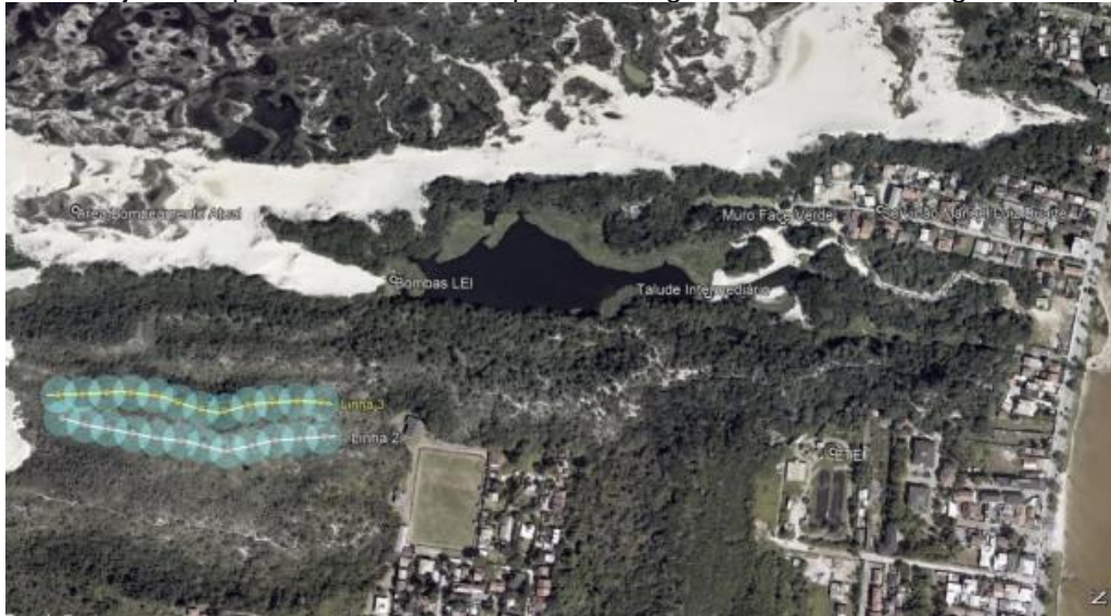
Figura 33. Projeto das possíveis áreas de aspersão da água da LEI da ETE Lagoa da Conceição
