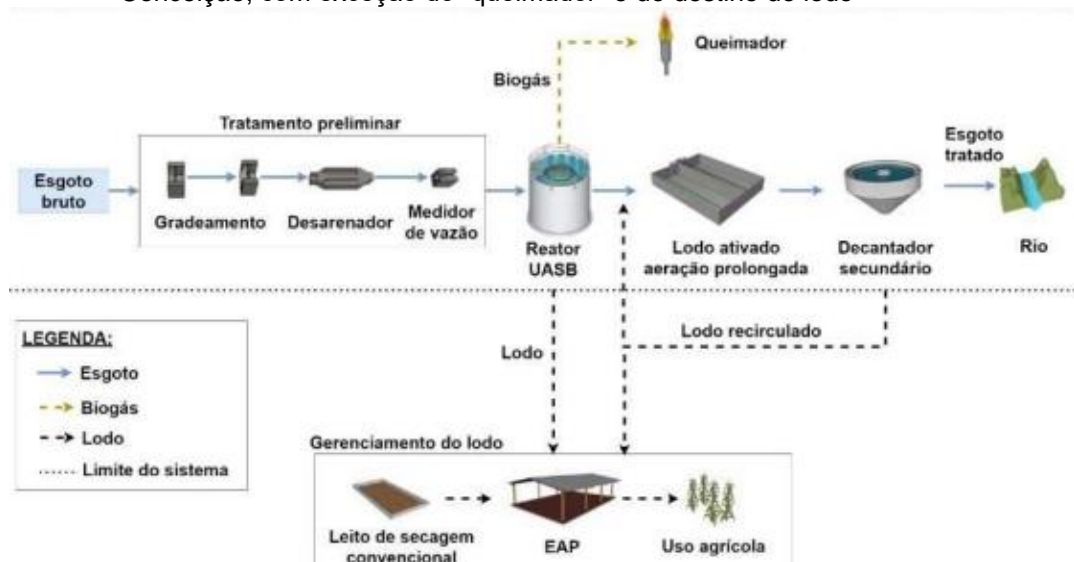
Figura 2. Esquema das etapas de tratamento de esgoto similar ao da ETE CASAN – Lagoa da Conceição, com exceção do “queimador” e do destino do lodo
