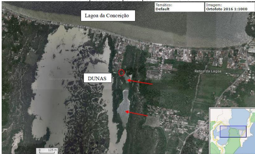
Figura 7. Localização das Lagoas de Evapoinfiltração da ETE CASAN – Lagoa da Conceição. Nas setas vermelhas estão as LEIs, entre as dunas e a Lagoa da Conceição. O local da ruptura de talude está representado pela elipse em vermelho
