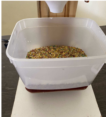
Figura 30 – 476 gramas de ração no sensor do protótipo
