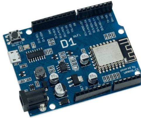
Figura 3 – Placa Wemos D1 R1, com processador ESP8266
