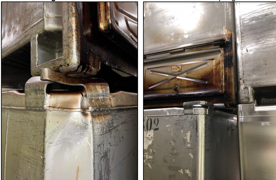
Figura 42 – Totes armazenados de forma errada e perigosa
