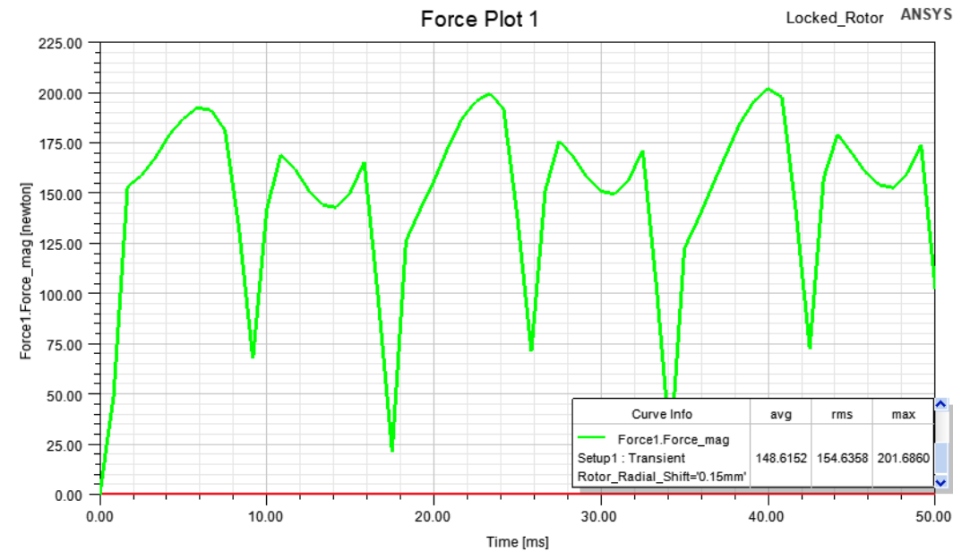
Figura 22: Gráfico de força no tempo para rotor bloqueado, sem inclinação das barras da gaiola do rotor e com excentricidade
