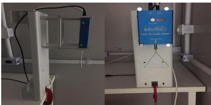
**Figura 2. Teste de força de preensão. Fonte: autor**
