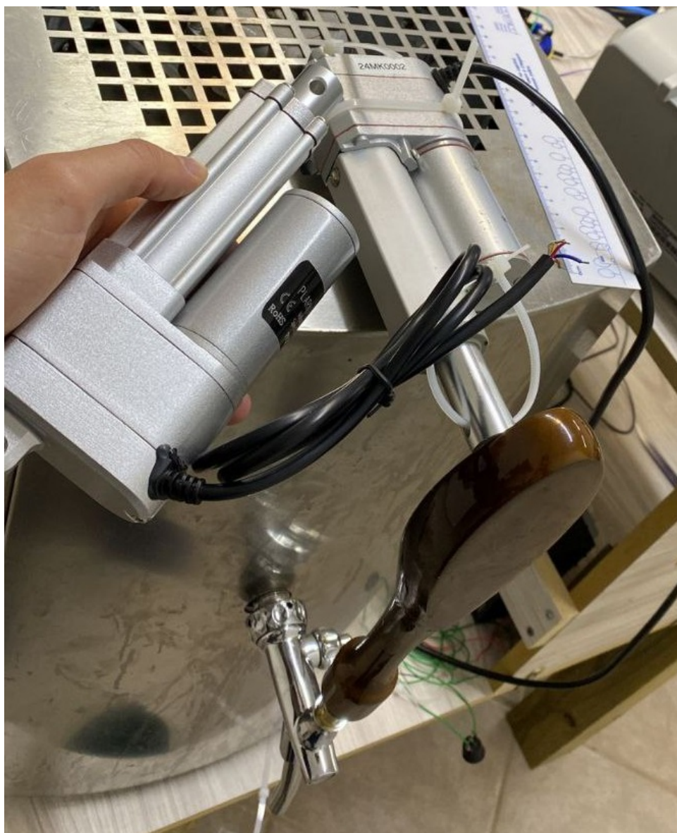
Figura 8 – Montagem de protótipo em chopeira.
