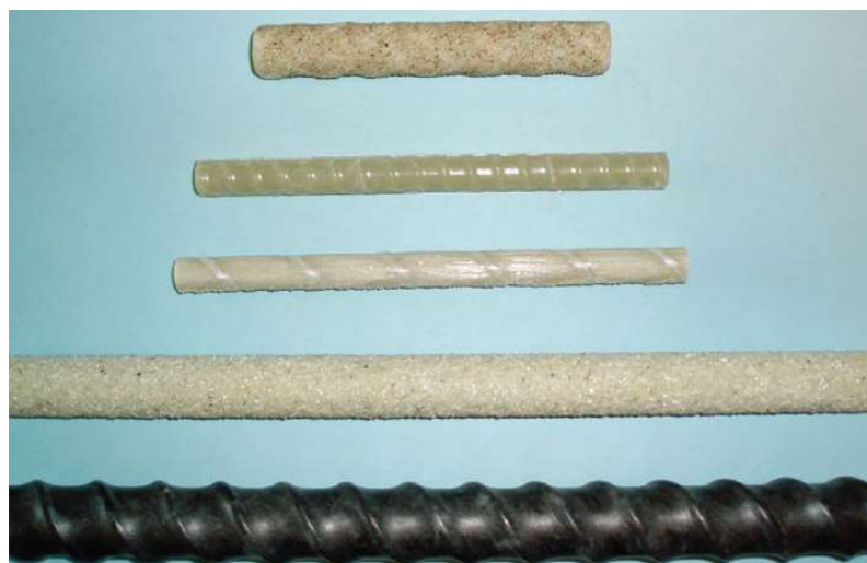
Figura 4 - Tipos de acabamento superficial das barras FRP
