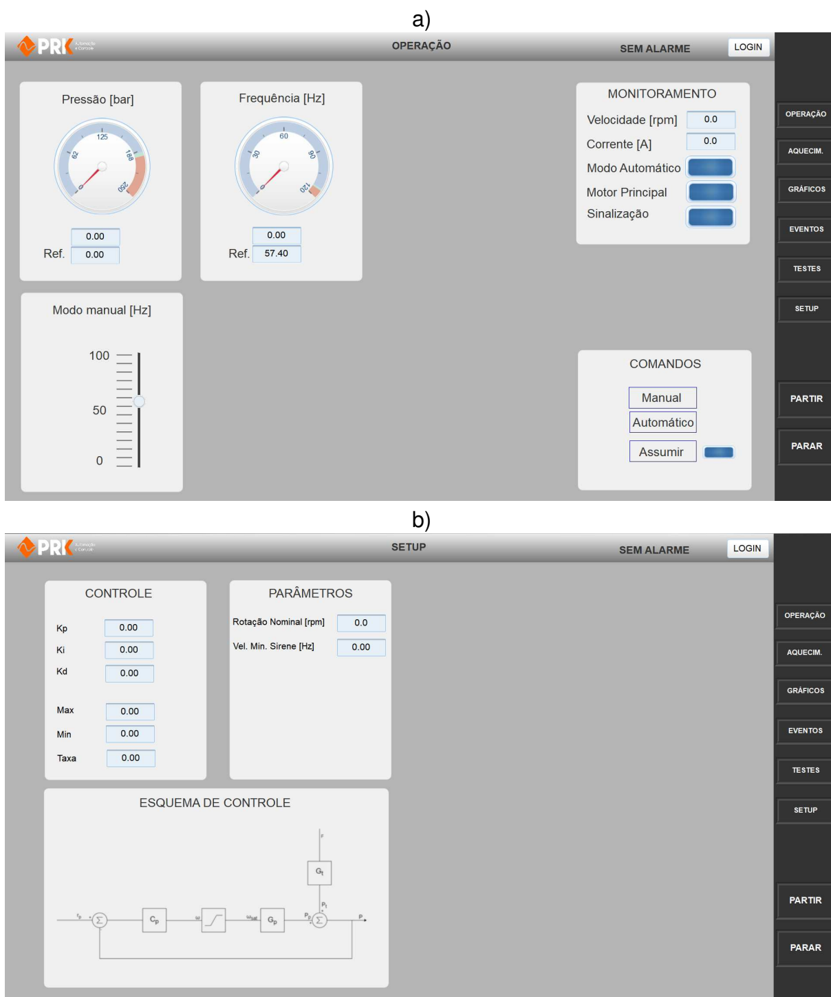
Figura 22 – Registros das telas de operação e setup desenvolvidas para testes iniciais.
