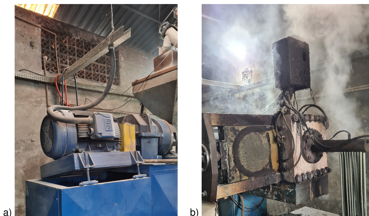
Figura 19 – Registros do motor principal e do trocador de tela da máquina extrusora utilizada em testes.
