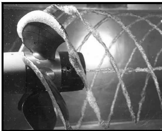
Figura 17 – Exemplo de cavitação no bordo de ataque de uma pá.
