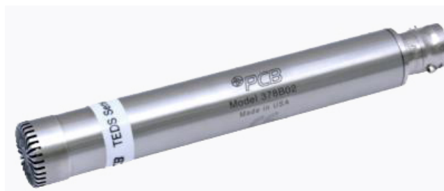
Figura 32 – Sensor acústico utilizado para leitura de sinais sonoros.
