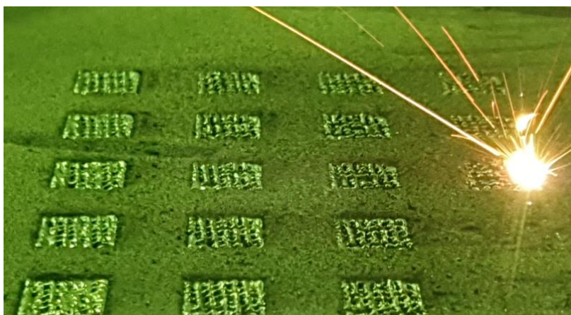
Figura 12 - Processo de fabricação das amostras via fusão em leito de pó a laser. Fonte: A autora.
