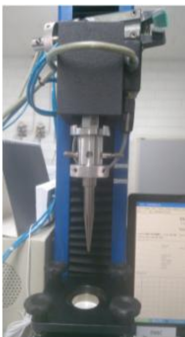
Figura 11 - Ensaio de resistência à perfuração
