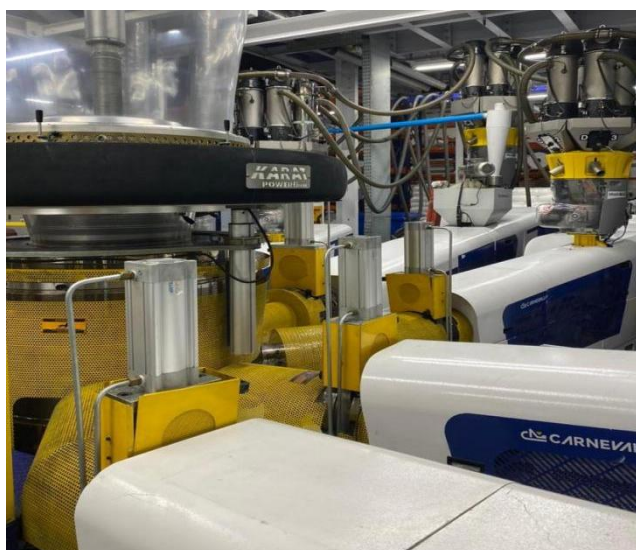
Figura 4 - Fotografia de máquina coextrusora de cinco extrusoras
