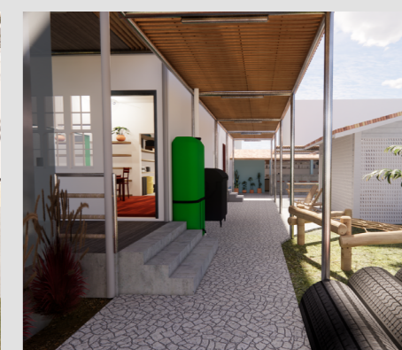
Imagem 127: cobertura com cisterna e PEV de eletrônicos. Elaborado pela autora (2023).
