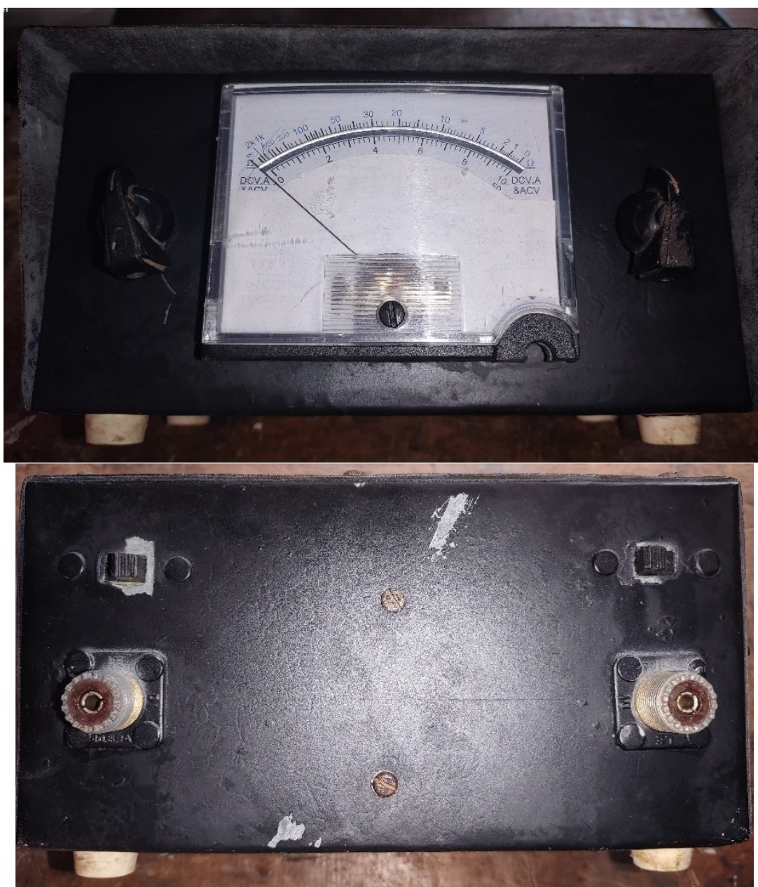
Figura 66- Vistas frontal e traseira do indicador de SWR caseiro utilizado nos ajustes do sintonizador.
