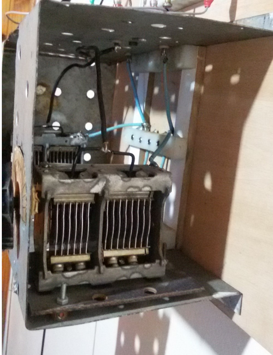
Figura 63- Vista lateral do sintonizador, mostrando os dois capacitores variáveis CV1 e CV2 .
