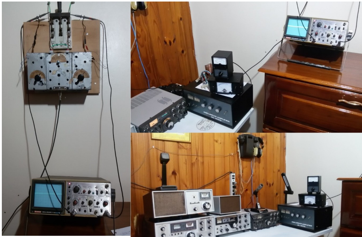
Figura 69- Medida de equilíbrio na linha bifilar. Ponteiras do osciloscópio.
