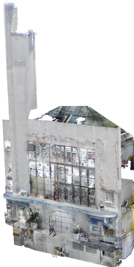
Figura 41 - Parte da Nuvem de Pontos no software Archicad vista pela fachada da rua Padre Miguelinho.
