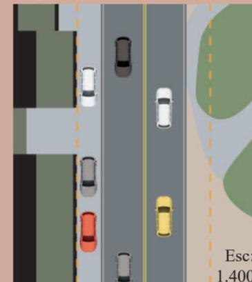
Compreendendo que as ocupações irregulares do espaço de calçada e a priorização do acostamento reduzem a caixa de via que teoricamente teria cerca de 18m(Rod. + Acost. + Passeios + Ciclofaixa) à cerca de 11m(Rod. + Acost.) ocorre a releitura do caminho, removendo status de Rodovia e reassimilando como eixo alternativo de transporte.
