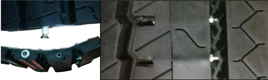
**Figura 3: Fixação do cabedal com parafusos e buchas. Fonte: elaborado pelos autores.**
