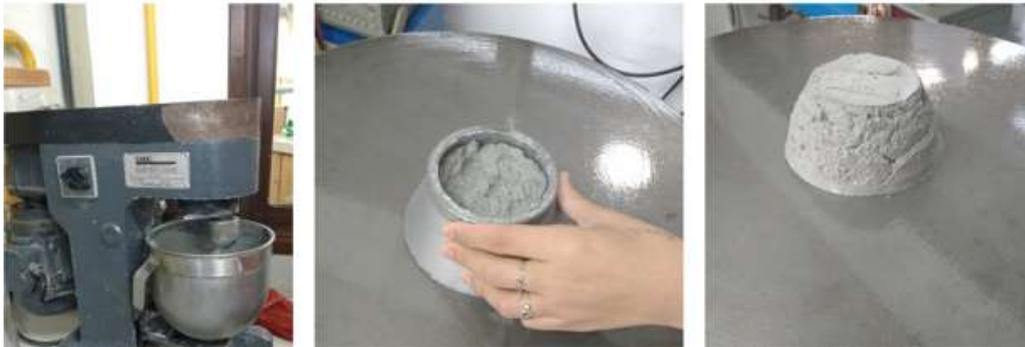
**Figura 3: Argamassa preparada no misturador mecânico e adicionada ao molde tronco cônico. Fonte: Elaborado pelos autores**
