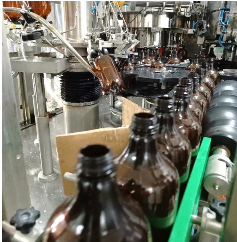
Figura 2. Envasadora adaptada com kit arrolhamento de garrafas PET.
