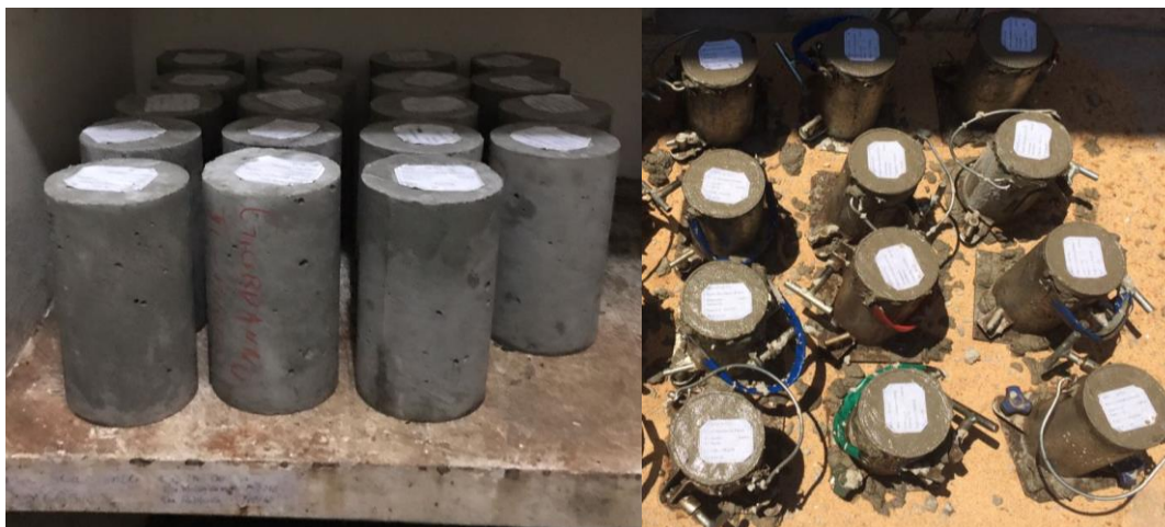
Figura 3: Corpos de prova moldados e em processo de cura em câmara úmida. Fonte: autores.
