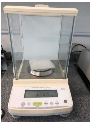
Figura 25 - Pesagem da amostra inteira
