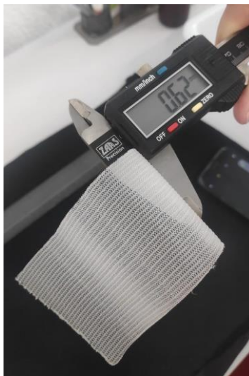
Figura 26 - Medição da espessura com paquímetro
