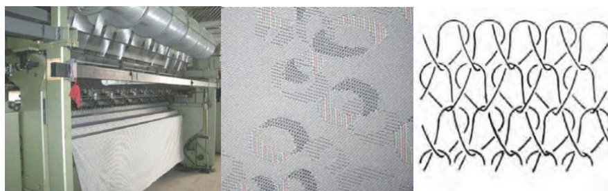
Figura 13 - Tear e representação da malha por urdume
