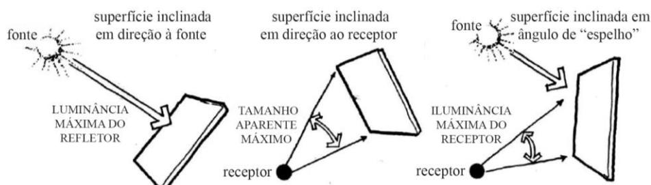
**Figura 1 - Inclinação ideal de refletor difuso para máxima iluminância do ponto receptor.**
