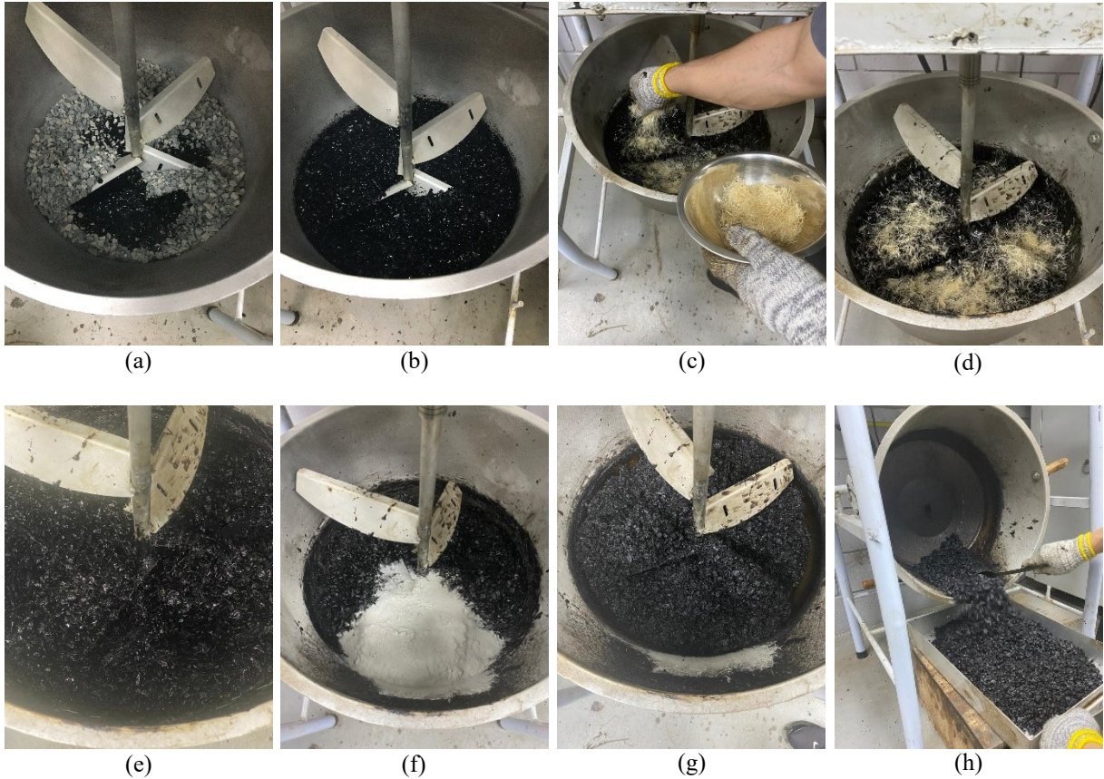
Figura 4.15 – Usinagem das misturas asfálticas com incorporação de fibras de sisal.
