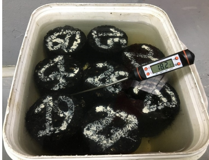
Figura 4.24 – Condicionamento dos corpos de prova em imersão em água à temperatura de 18\text{ °C} \pm 1\text{ °C} .
