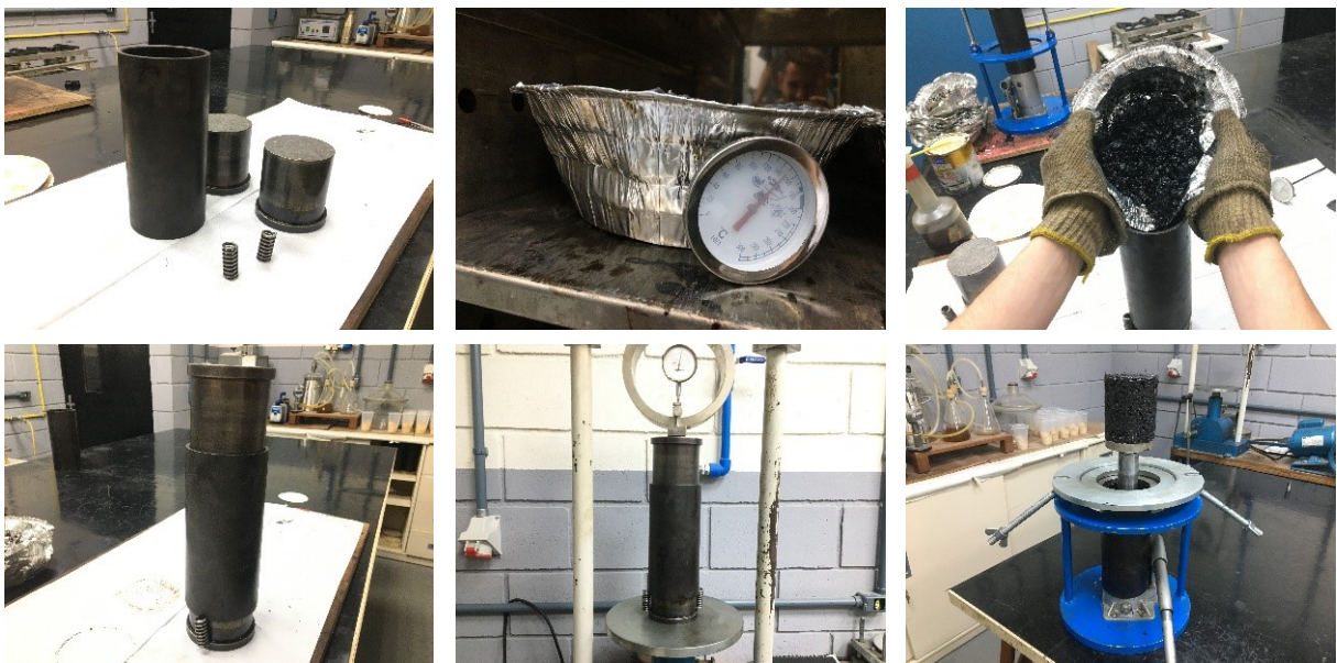
Figura 4.21 – Procedimentos de compactação por duplo pistão no ensaio Duriez.
