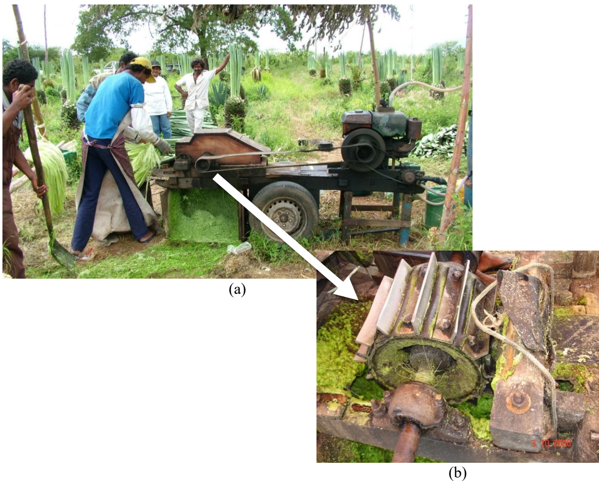
Figura 3.5 – (a) Máquina desfibradora paraibana em operação e (b) detalhe do rotor de raspagem.
