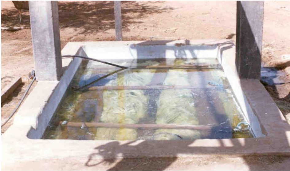
Figura 3.6 – Imersão da fibra de sisal em tanque com água para retirada de impurezas.
