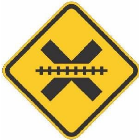
Figura 26 - Passagem em nível sem barreira
