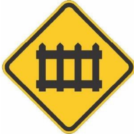
Figura 27 - Passagem em nível com barreira
