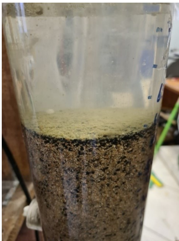
Figura 50 - Retenção de partículas em suspensão e sedimentação da espuma sobre o meio filtrante areia
