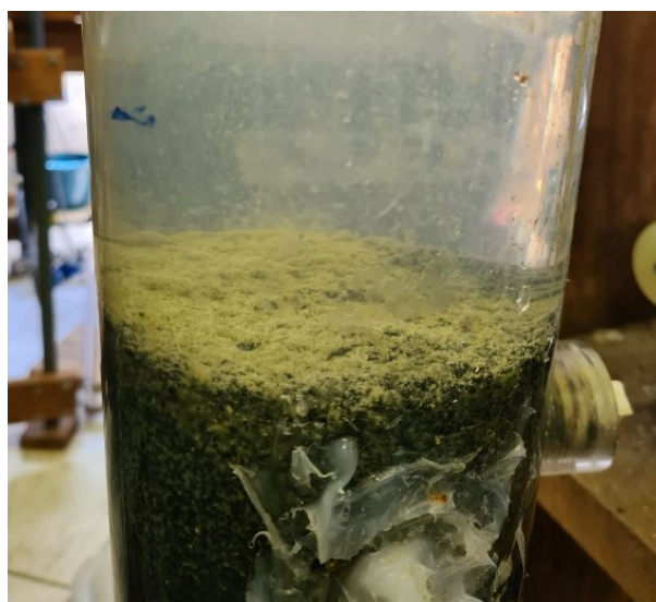
Figura 54 - Retenção de partículas em suspensão e sedimentação da espuma sobre o meio filtrante areia e carvão antracito
