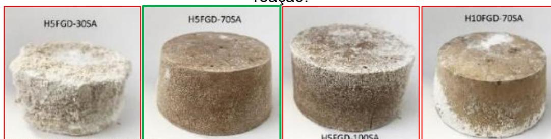
Legenda: H (5,10) FGD pasta álcali-ativada com substituição de 5% e 10% da CST por FGD, SA teor de solução alcalina.
