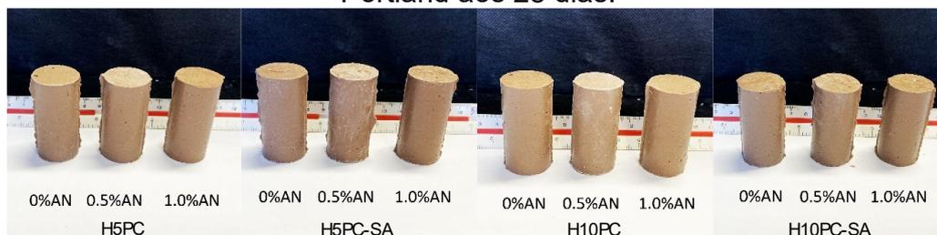
Legenda: H(5,10)PC pasta álcali-ativada com substituição da lama por cimento Portland em 5% e 10%, respectivamente, AN teor de aditivo natural, H(5,10)PC-SA pastas álcali-ativadas com 100% de solução alcalina.
