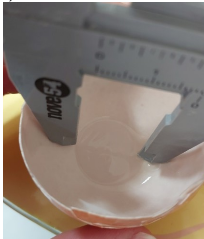
Figura 7 – Mensuração da câmara de ar através de paquímetro manual
