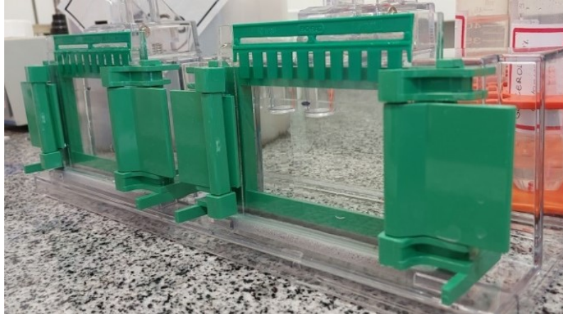
Figura 15 – Molde plástico introduzido sob o gel de entrada (4%), nas duas placas
