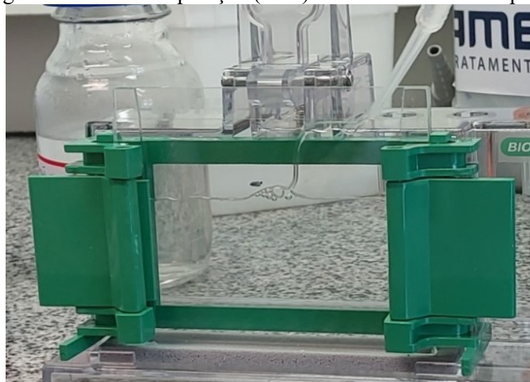
Figura 14 – Gel de separação (12%) sendo introduzido na placa
