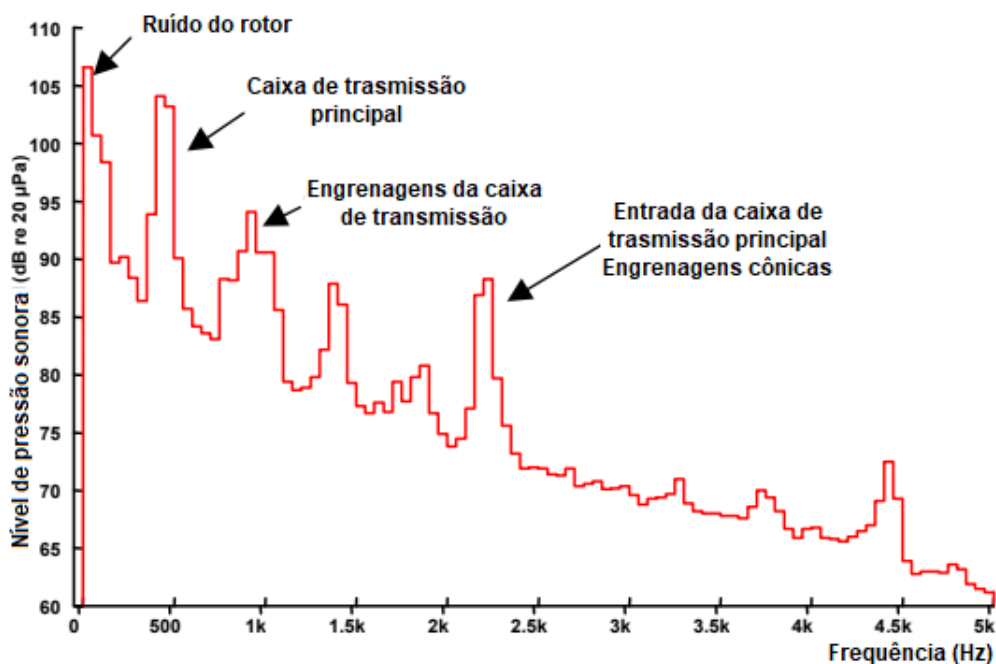
Figura 10 – Análise de banda estreita do ruído da cabine do helicóptero Lynx 100kt (JAMES, 2005)
