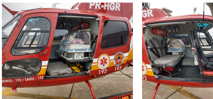
Figura 18 – Posicionamento da incubadora no interior da aeronave AS350 B2
