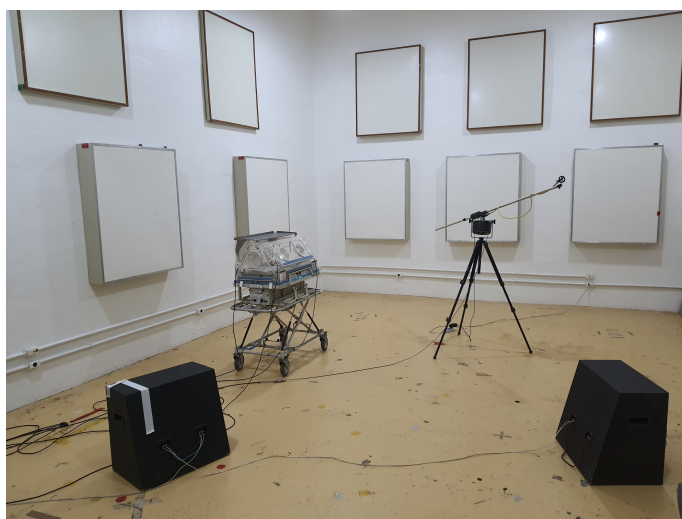
Figura 24 – Configuração de medição - Câmara Reverberante
