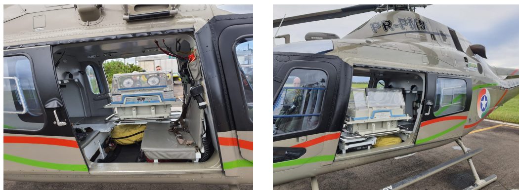
Figura 20 – Posicionamento da incubadora no interior da aeronave AW119 MkII
