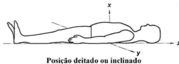
Figura 15 – Orientação dos eixos de medição do acelerômetro triaxial na posição deitada
