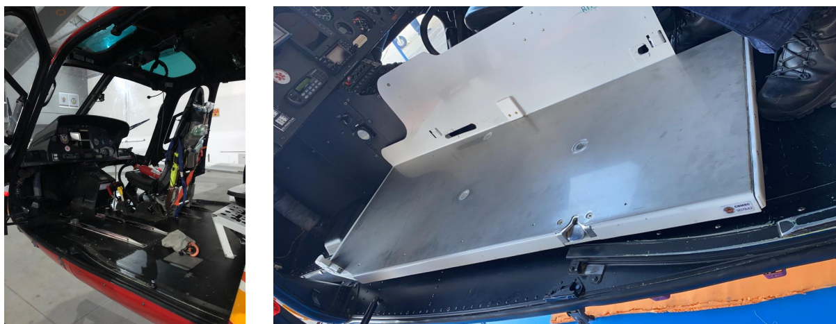
Figura 79 – Fixação do kit aeromédico na aeronave AS350 B2, prefixo PR-BNU.
