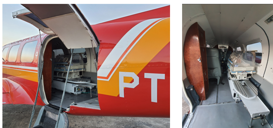
Figura 21 – Posicionamento da incubadora no interior da aeronave EMB-820C
