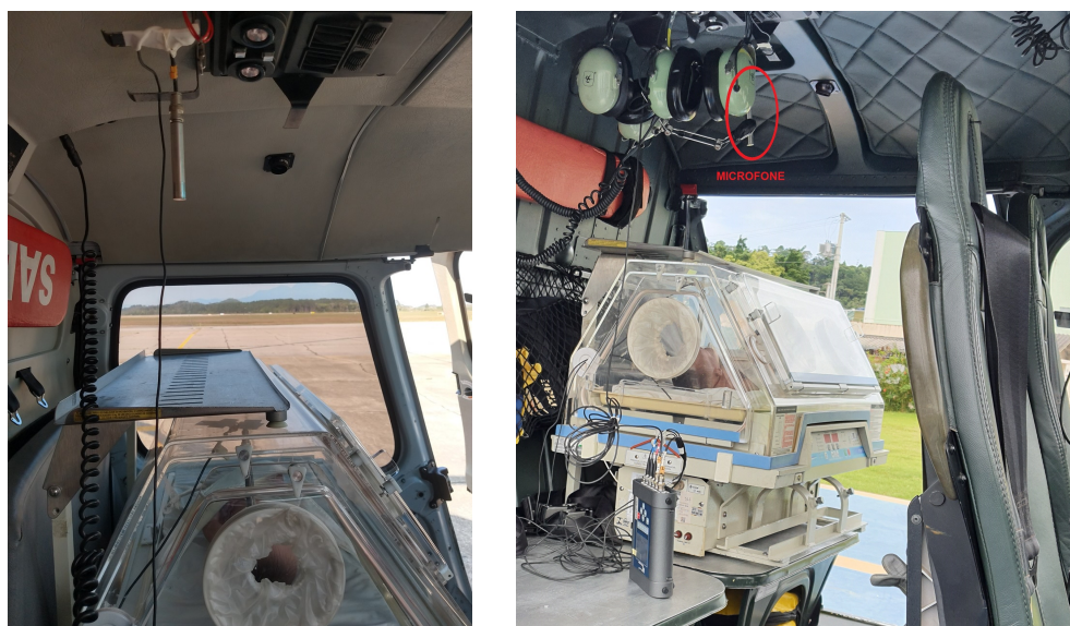
Figura 12 – Posicionamento do microfone no interior da cabine da aeronave AS 350 B2. Esquerda: PR-HGR - Arcanjo-1. Direita: PR-HGH - Águia-07.
