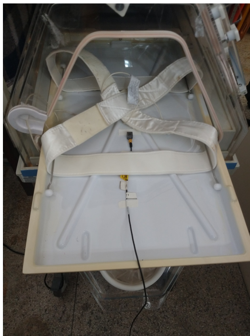
Figura 16 – Posição do acelerômetro triaxial na bandeja plástica da incubadora
