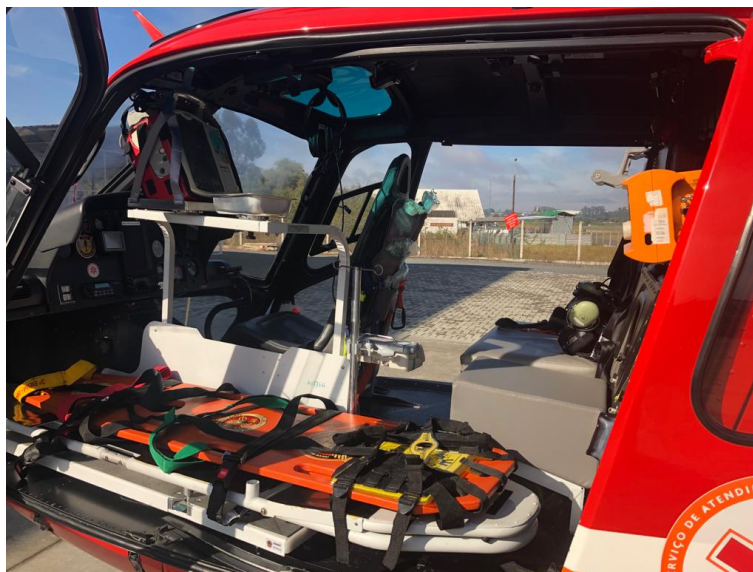
Figura 80 – Maca do kit aeromédico da aeronave AS350 B2, prefixo PR-BNU.
