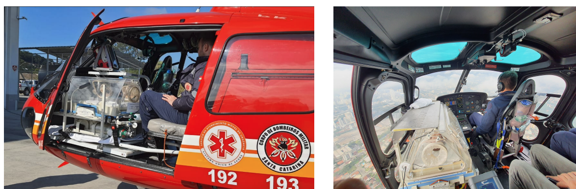
Figura 19 – Posicionamento da incubadora no interior da aeronave AS350 B2, prefixo PR-BNU, sobre a maca do kit aeromédico.
