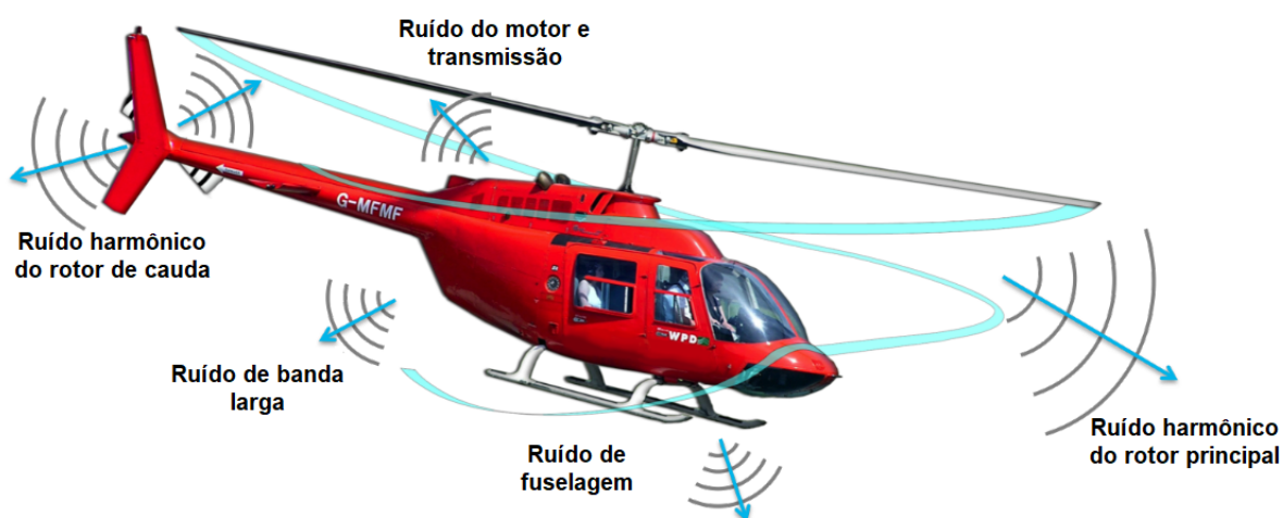
Figura 9 – Fontes de Ruídos em Helicópteros (SWADESIR; BIL, 2018)
