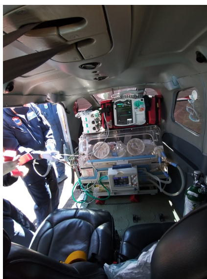
Figura 22 – Posicionamento da incubadora no interior da aeronave C206H
