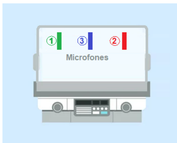
Figura 54 – Posição dos microfones no interior da cúpula da incubadora para as medições na câmara reverberante.
