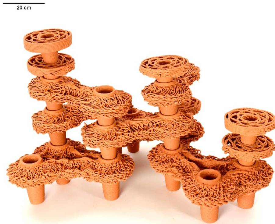
Figura 5 - Sistema modular de recife de corais artificial impresso com argila do tipo terracota.
