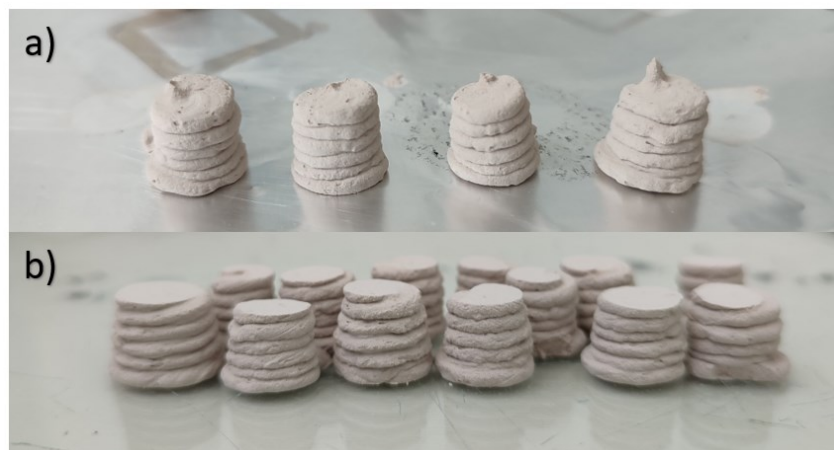
Figura 13 - Fotografias dos corpos de prova do ensaio de compressão: a) amostras brutas; e b) amostras com as superfícies lixadas.
