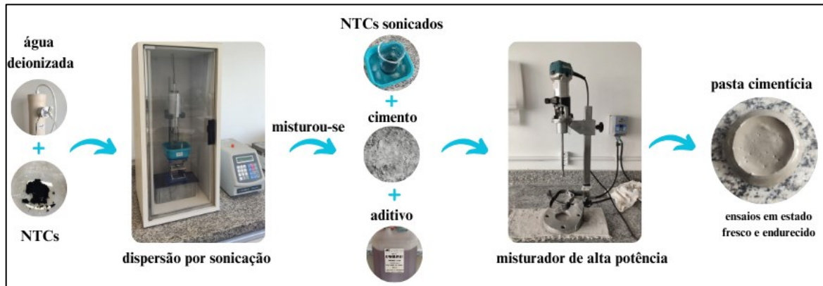
Figura 26 - Representação esquemática do preparo das pastas cimentícias para a realização dos ensaios em estado fresco e endurecido.
