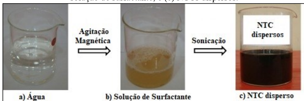
Figura 12 - Preparação da solução de surfactante de NTC dispersos em água; (a) água; (b) solução de surfactante; e (c) NTCs dispersos.
