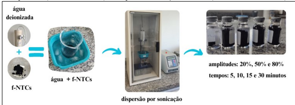
Figura 24 - Representação esquemática da preparação das amostras sonicadas em diferentes amplitudes (20%, 50% e 80%) e tempos de sonicação distintos (5, 10, 15 e 30 minutos).
