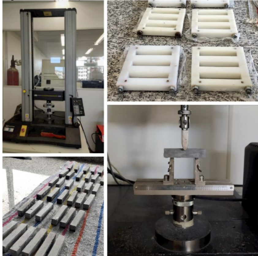
Figura 33 - Realização do ensaio de resistência à tração na flexão.
