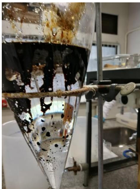
Figura 13 – Funil de separação das fases petróleo e água produzida
