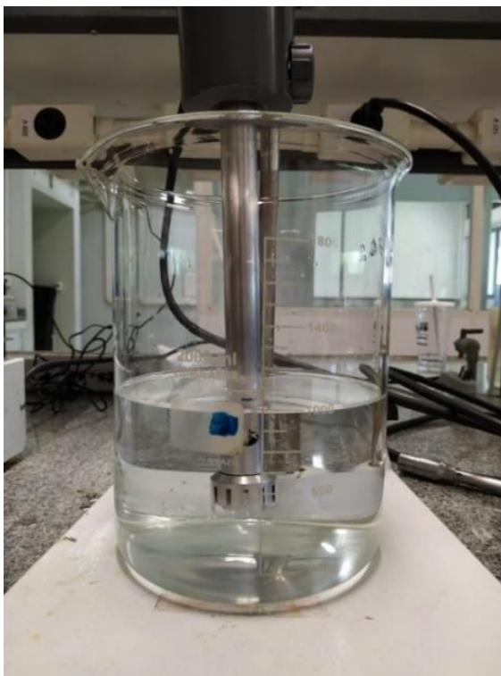
Figura 12 – Sistema de agitação das fases pelo ultraturrax
