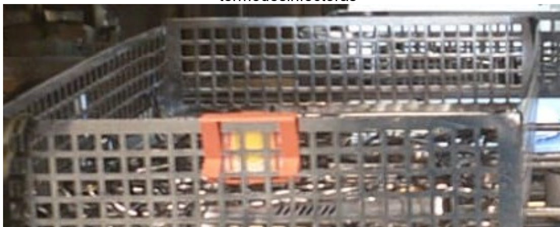
Figura 9 – Posicionamento do dispositivo do teste GKE em cestos para lavadoras termodesinfectoras
