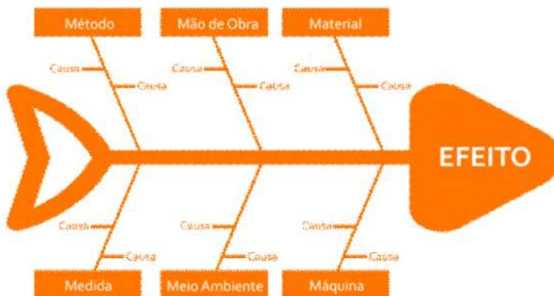
Figura 1 – Estrutura de um diagrama Ishikawa Fonte: Imagem retirada do site [www.napratica.org.br](http://www.napratica.org.br)
