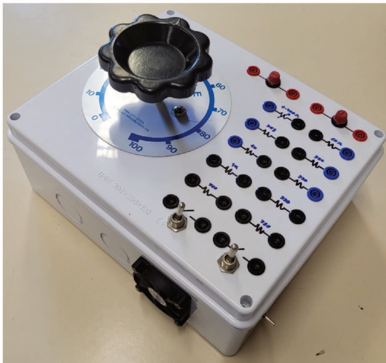
Figura 6.1 – Caixa de contatos dos resistores da nova versão da ponte de Schering
