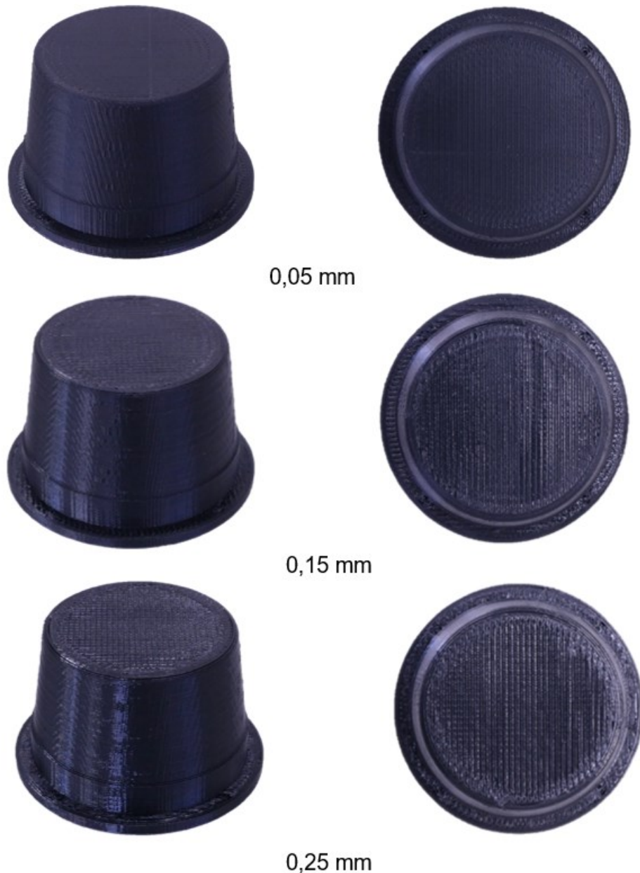
Figura 42 – Vista lateral e vista superior dos moldes fabricados para as três espessuras de camadas empregadas
