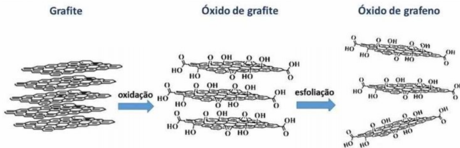
Figura 10 - Esquema de obtenção do óxido de grafeno por oxidação do grafite seguida de esfoliação mecânica
