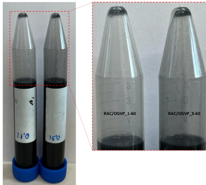
Figura 32 – Avaliação da estabilidade da suspensão de óxido de grafeno nas amostras RAC/OGVP_1-60 e RAC/OGVP_3-60
