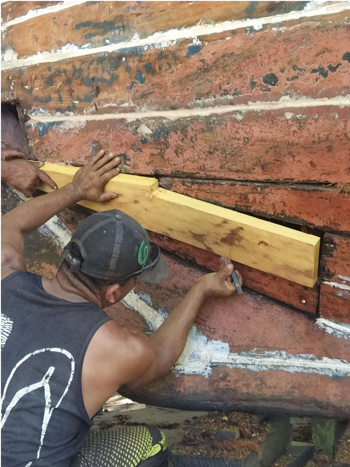
Figura 16 Troca de peça feita pelo carpinteiro.
