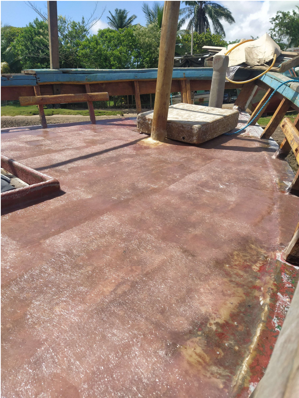
Figura 22 Superfície um uma segunda camada de fibra recém-aplicada.
