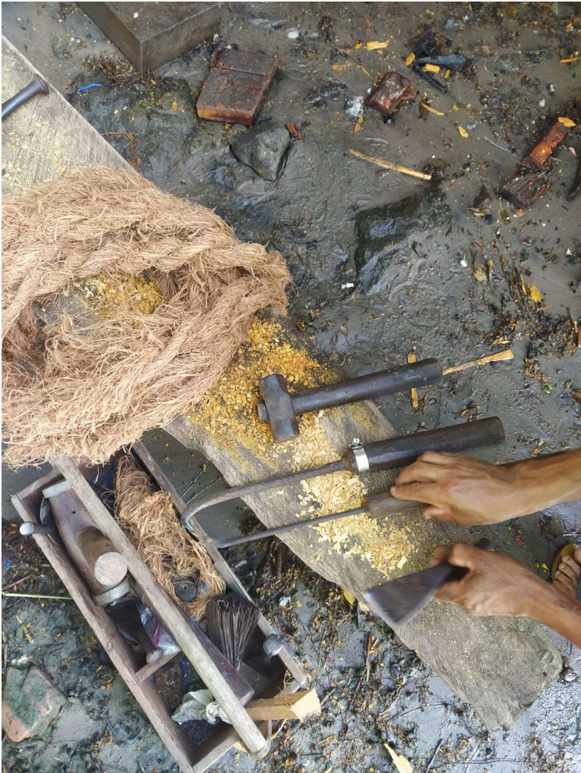
Figura 15 Troca de ferramentas, maunjo → ferro de corte.
