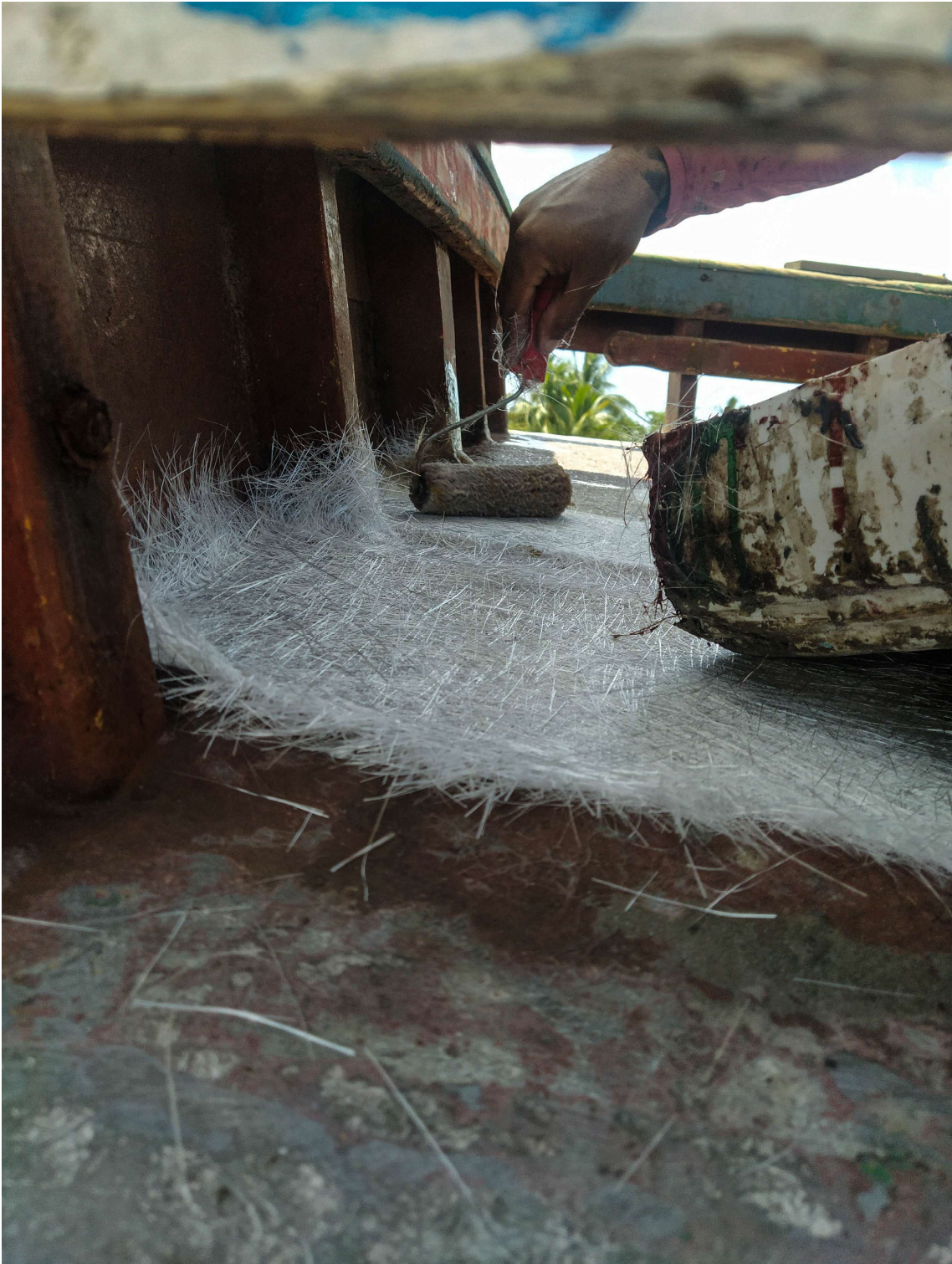
Figura 21 Aplicação da base de cola na fibra com o rolo.
