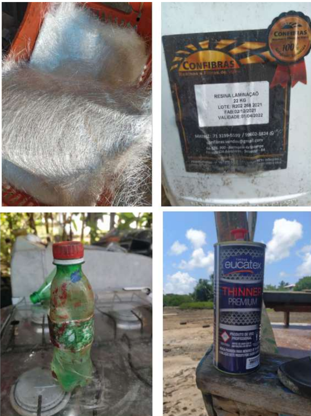
Figura 20 Fibra de vidro, resina plástica, atalisador em uma minigarrafa pet, tinner.
