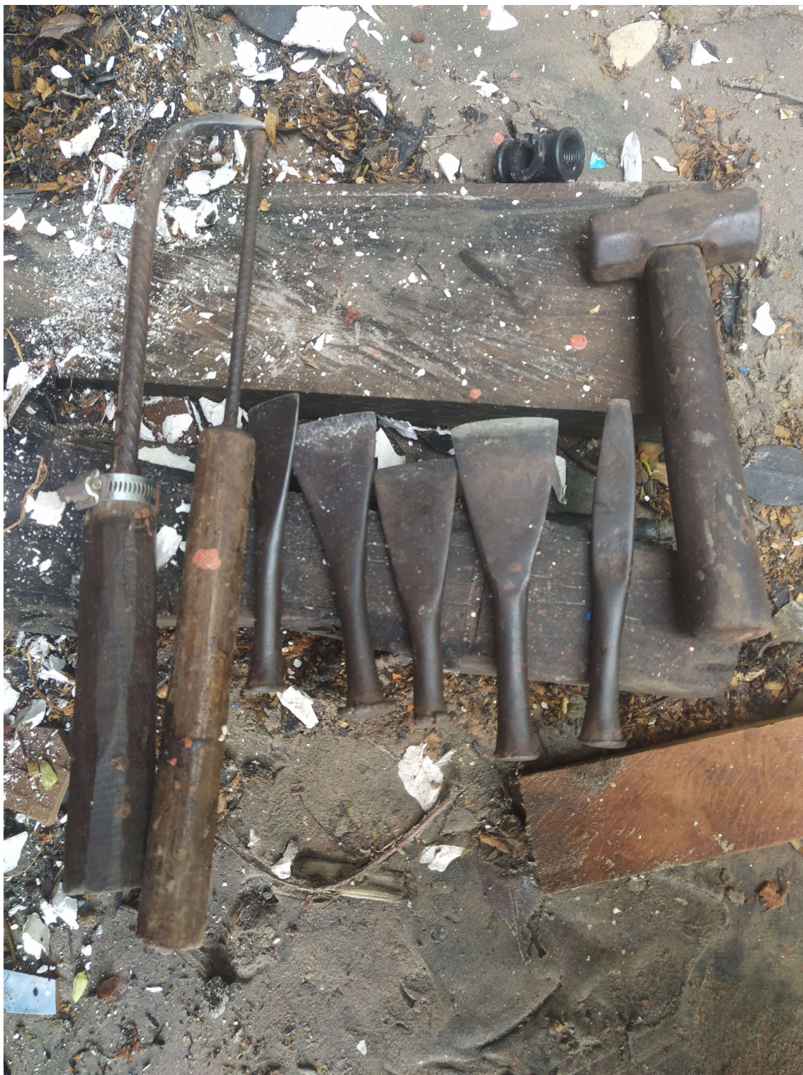
Figura 12 Maunjo, chaviscador, aribeira, carcané fino, carcané grosso, ferro de corte, ferro de ponta e martelo.
