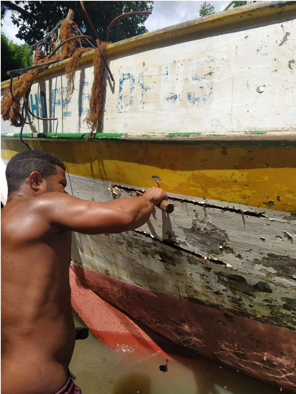
Figura 14 Retirada da antiga calafetagem com o macetador e o chuviscador;
