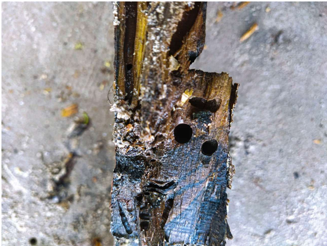
Figura 11- Gonzaga relata uma experiência que fez com madeiras de lei e indicou que nenhuma madeira é imune ao gusano, porém, notou maior resistência no cedro, peroba-rosa e angelim, em alguns casos, os gusanos mediram 15 cm de comprimento e um diâmetro de 1,5 cm (GONZAGA, 2006). A imagem se trata de uma tábuca de jaqueira recém-trocada do casco de um saveiro, nota-se as galerias de gusano com aproximadamente 2 a 3 cm de diâmetro.
