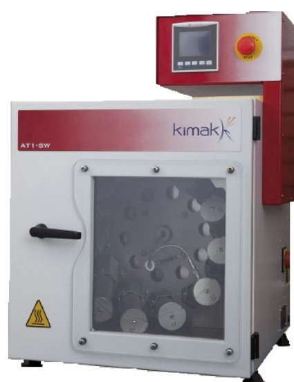
Figura 17 – Máquinas de tingir Kimak, modelo AT1-SW.
