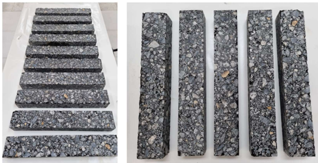
Figura 3.14: Corpos de prova prismáticos de mistura modificada com látex para os ensaios de módulo dinâmico e desempenho à fadiga.
