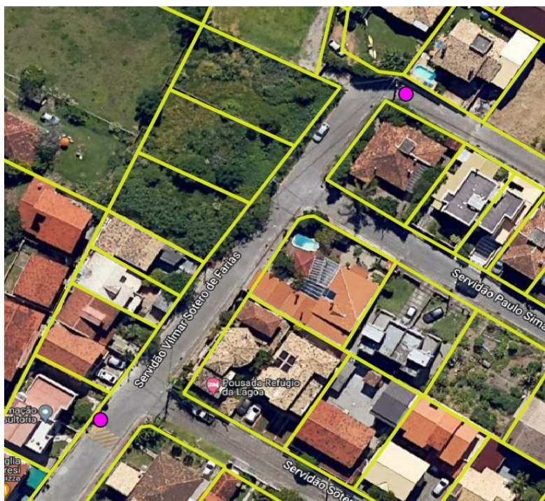
Figura 17 – Exemplo de pontos geocodificados com precisão “ROOFTOP” (classe mais precisa a nível de porta), mas que não cruzavam com lotes cadastrais.
