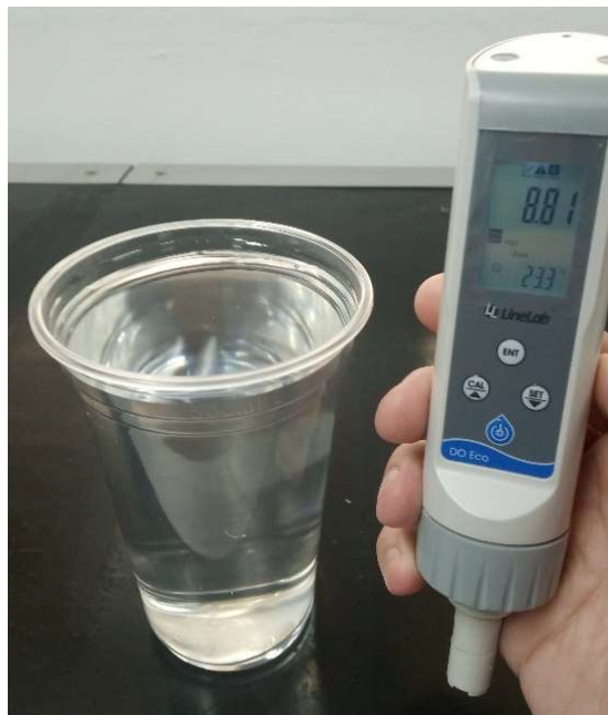
Figura 3.3 – Equipamento utilizado para medição de oxigênio dissolvido em água
