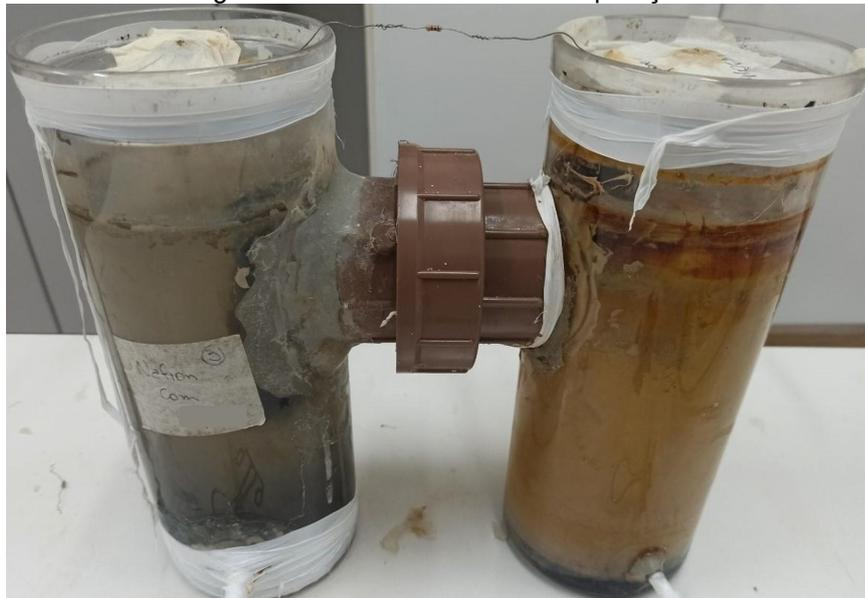
As duas CCMs operaram em batelada alimentada por 80 dias conectadas a uma resistência de 1 k $\Omega$ , e a evolução de seus potenciais foi monitorada com auxílio de multímetro digital. Foram obtidas duas curvas de polarização para a CCM 1 nos
