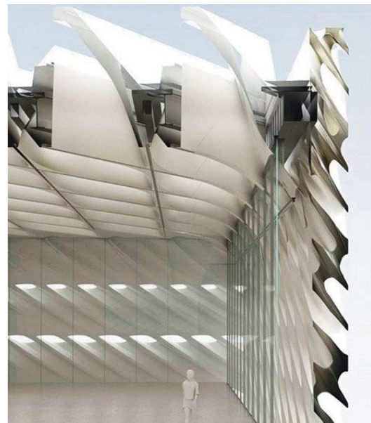
Figura 34. Corte do museu Broad em Los Angeles, EUA mostrando elemento de sombreamento complexo.
