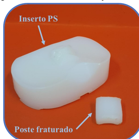
Figura 45 – Inseto tibial PS com poste fraturado.
