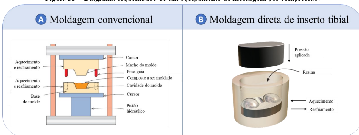
Figura 33 – Diagrama esquemático de um equipamento de moldagem por compressão.
