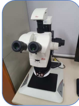
Figura 56 – Esteriomicroscópio Leica. Modelo: M165 C.
