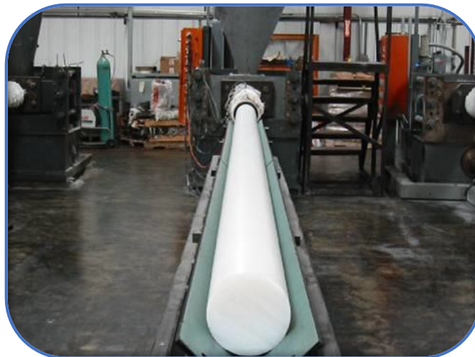
Figura 32 – Barra de PEUAPM manufaturada por extrusora RAM.
