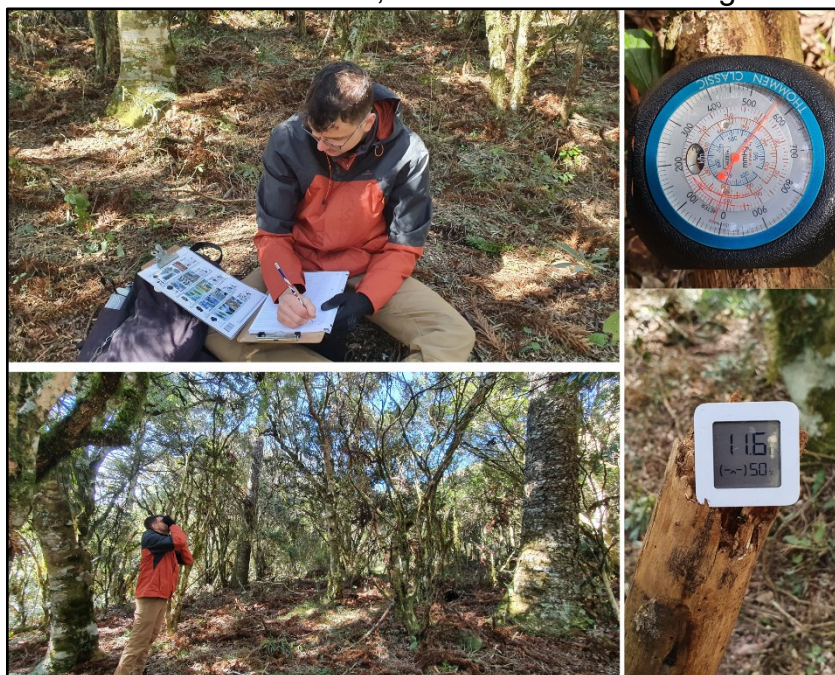
Figura 17: Registro do levantamento em campo, com instrumentos utilizados (Cademeta e referências. Clinômetro, Altimetro e termômetro digital.
